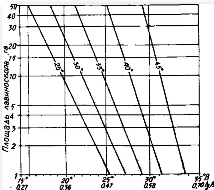
Рис. 7. Величины коэффициента общего сопротивления движению лавины  $\text{tg } \beta$  и соответствующего угла  $\beta$  для лотковых лавин в зависимости от площади лавиносбора и углов наклона его поверхности
