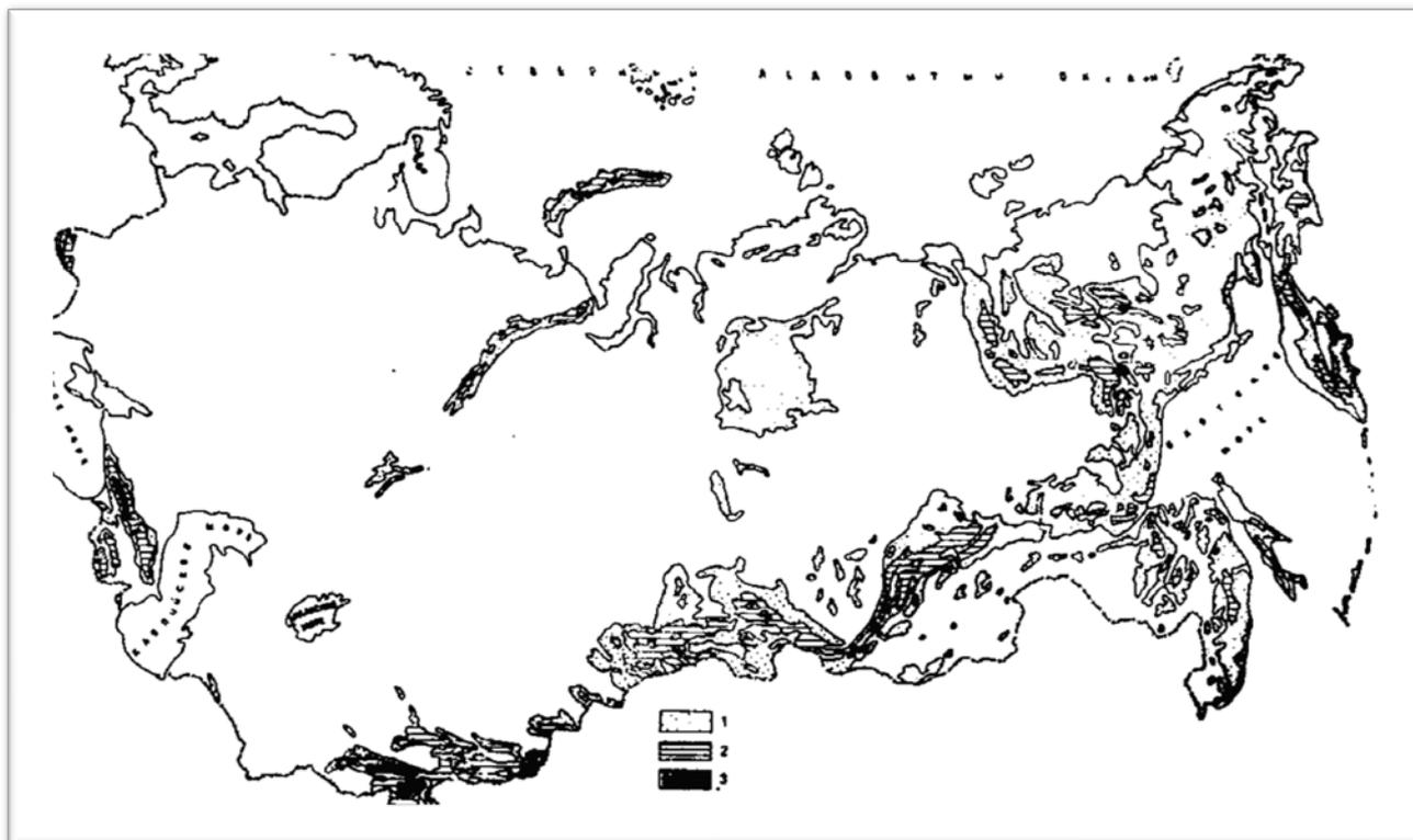
Рис 77. Удорожание строительства автодорог в СССР за счет защиты от лавин инженерными сооружениями для долин с широким дном: 1 - до 100±50%; 2 - от 100±50 до 300+150%; 3 - более 300±150%
