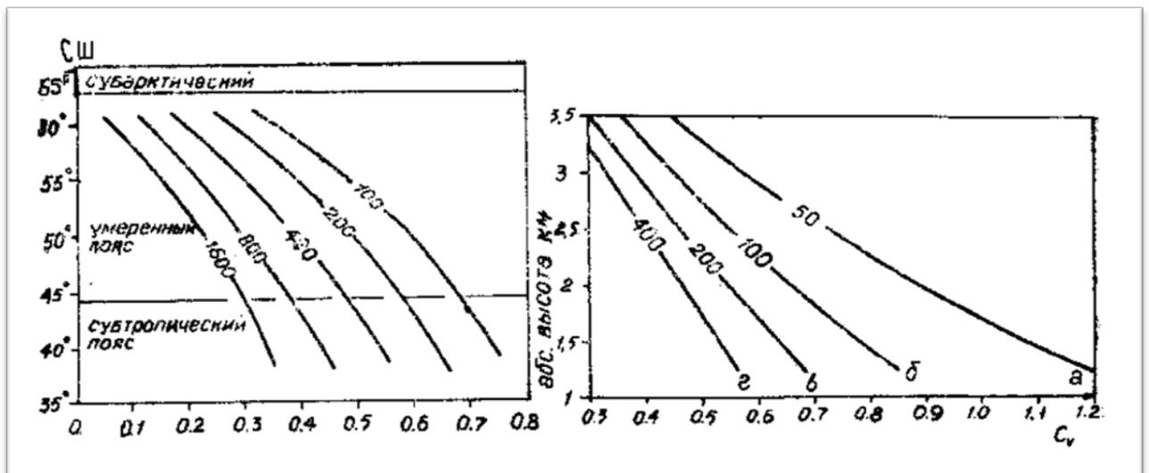
Рис. 24. Коэффициент вариации  $C_v$  снегов запаса  $W$  (величины  $W$  подписаны на кривых, мм) на наветренных склонах гор Западного побережья Северной Америки, на разных широтах. По данным М. И. Геткера и Т. Э. Ивановской
