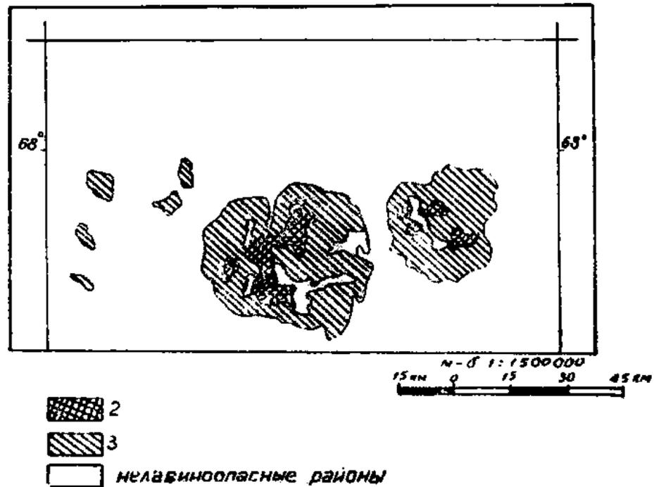
Рис. 52. Хибины, Полярный Урал. Средние суммарные объемы лавин за зиму из очага средних размеров: 1 — более 100 000 м<sup>3</sup>; 2 — 10 000—100 000 м<sup>3</sup>; 3 — менее 10 000 м<sup>3</sup>
