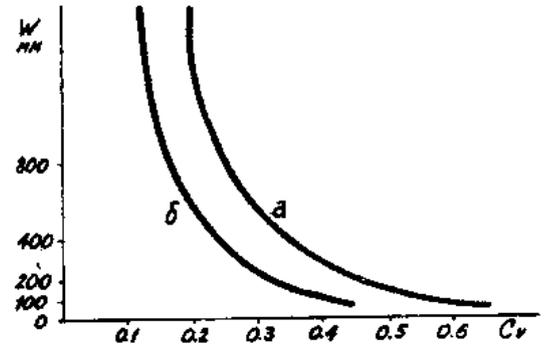
Рис. 23. Коэффициент вариации  $C_v$  максимального декадного снегов запаса  $W$  в горах Западного побережья Северной Америки: а — на наветренных, б — на подветренных склонах. По данным М. И. Геткера и Т. Э. Ивановской
