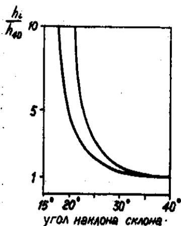
Рис 1. Отношение критической высоты сухого снежного покрова  $h_c$  на склонах с разными углами наклона к его критической высоте на склоне с углом наклона  $40^\circ$   $h_{40}$  при значениях  $\operatorname{tg} \varphi = 0,36$  (правая) и  $\operatorname{tg} \varphi = 0,30$  (левая кривая)
