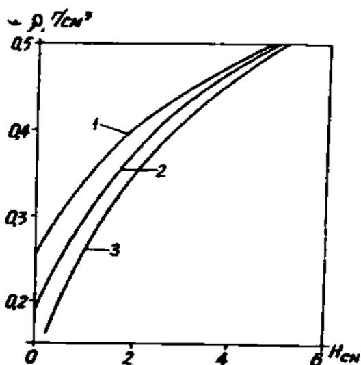
Рис. 18. Характерная плотность снега  $\rho$  при различной высоте снежного покрова  $H_{\text{ср}}$  для районов на 30—49° с. ш. (1), 50—59° с. ш.
