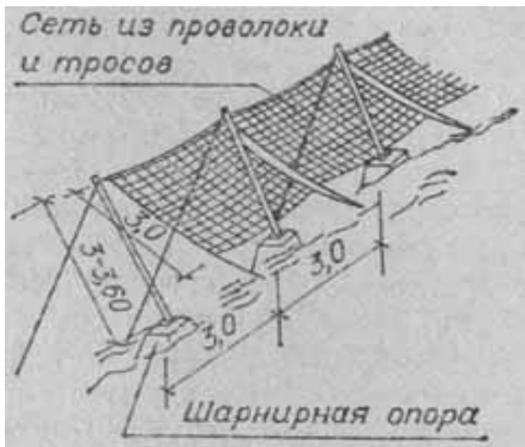
Рис. 35. Противолавинная сетка, Размеры указаны в метрах.
